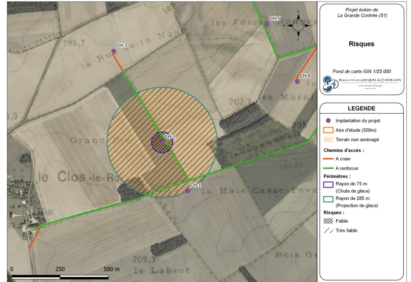
Carte 27 : Éolienne CH-2 – Risques liés à la chute et à la projection de glace (Source : BE Jacquel et Chatillon)
