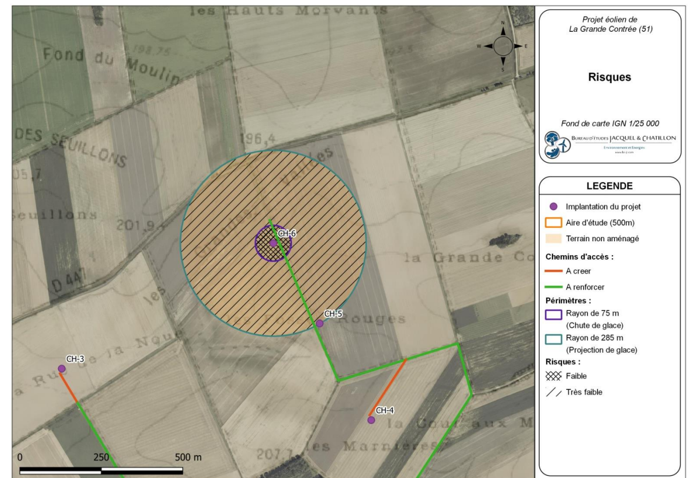
Carte 35 : Éolienne CH-6 – Risques liés à la chute et à la projection de glace (Source : BE Jacquel et Chatillon)
